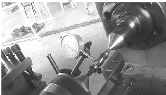
شکل ۳ اندازه‌گیری اعوجاج به روش دو مرگک و با استفاده از ساعت اندازه‌گیر با دقت ۰/۰۱ میلی‌متر
