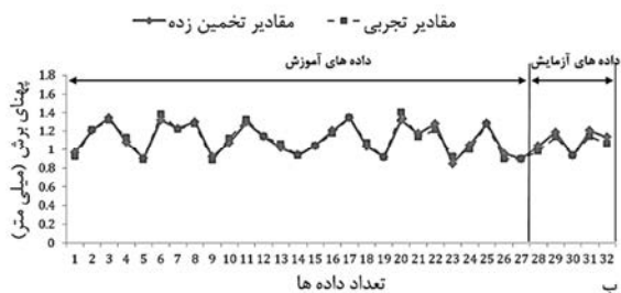
شکل ۳ مقایسه ی بین نتایج تجربی و نتایج خروجی از شبکه ی عصبی. الف. زبری سطح. ب. پهنای برش
