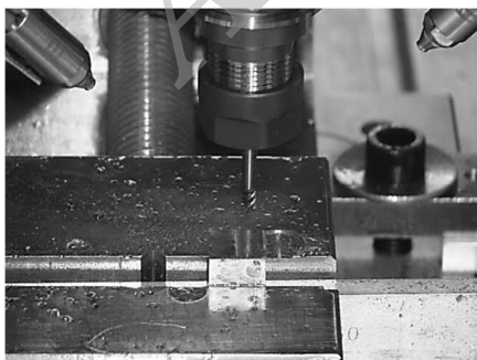
شکل ۱ چیدمان قطعه در آزمایش و موقعیت نازل‌های پاشش روان‌کار
