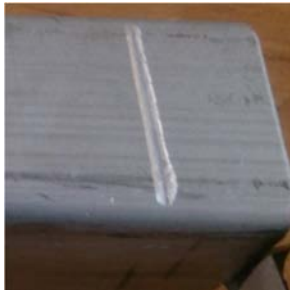
شکل ۵ نمونه منحنی ماشین کاری شده توسط دستگاه هگزپاد بر روی آلومینیوم
