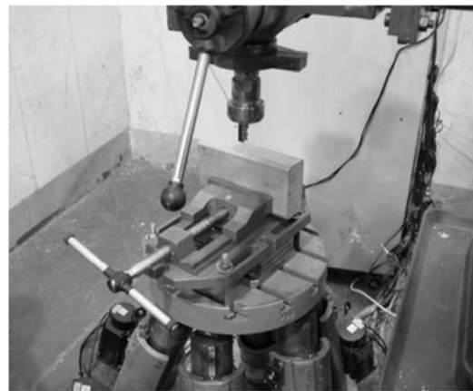
شکل ۱ مجموعه دستگاه هگزپا، فرز، گیره و قطعه کار
