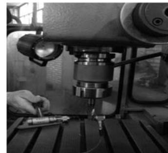
شکل ۳ نحوه انجام آزمایش مودال ابزار
