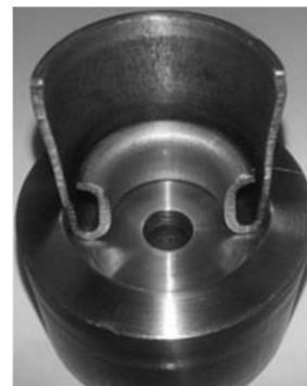
Fig. 6 Sectioned invertube on its respective die شکل 6 نمایی برش خورده از لوله وارونه شده در درون قالب مربوطه
