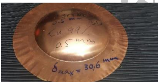
Fig. 7 Deflection of 0.5 mm copper plate during loading 1 gram T.N.T شکل 7 تغییر شکل ورق مسی با ضخامت 0.5 میلی‌متر تحت بارگذاری بار انفجاری حاصل از 1 گرم TNT
