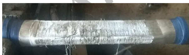
Fig. 26 Final form of the tube after being removed from the die شکل 26 شکل نهایی لوله بعد از خارج نمودن از قالب
