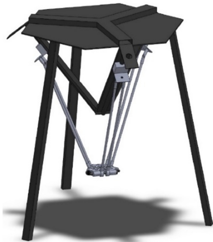
Fig. 1 Schematic of the 3-[P2(US)] parallel manipulator شکل 1 شماتیک ربات موازی 3-[P2(US)]
