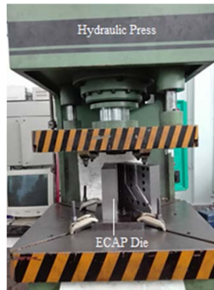
Fig. 4 Hydraulic press and ECAP die setup.
