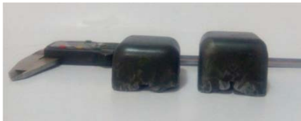
Fig. 13 Samples produced by hydro mechanical deep drawing with drawing ratios of 1.8 and 2.2 شکل 13 نمونه‌های تولید شده به روش کشش عمیق هیدرومکانیکی با نسبت کشش 1.8 و 2.2
