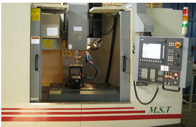
Fig. 9 Three axis CNC milling for incremental forming شکل 9 ماشین فرز کنترل عددی سه محوره مورد استفاده در شکل‌دهی تدریجی
