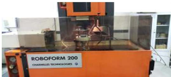
شکل ۳) دستگاه اسپارک مورد استفاده در فرآیند EDM به‌همراه میدان مغناطیسی و ارتعاشات التراسونیک
