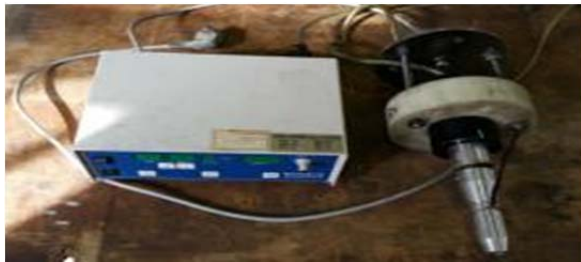
شکل ۱) تصویر دستگاه مولد ارتعاشات التراسونیک
