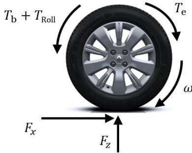
Fig. 4 Free body diagram of a wheel during accelerating شکل 4 نمودار جسم آزاد چرخ در حال شتاب‌گیری
