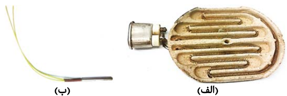
شکل ۲) گرم‌کن‌های الکتریکی برای حرارتی‌دهی به ورق و ابزار: (الف) ورق، (ب) ابزار
