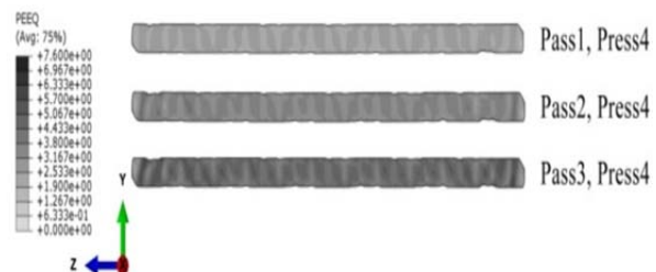
شکل ۱۱) توزیع کرنش موثر در سطح مقطع نمونه‌های CGP شده پس از پاس‌های اول، دوم و سوم
