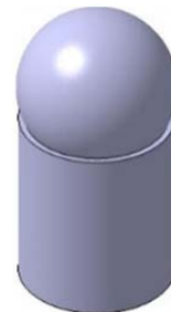
شکل ۲) طرح بدنه مازول شامل پایه سرکروی
