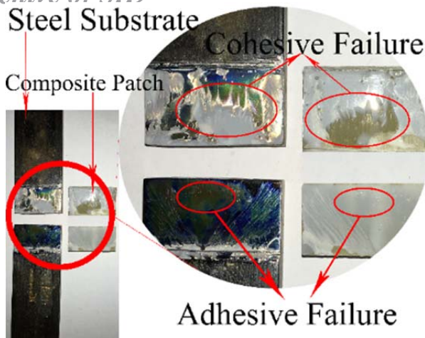
شکل ۵) تصاویر ماکروسکوپی از مقطع شکست کامپوزیت- فولاد
