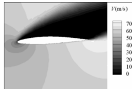
شکل ۷ (۷) کانتور جریان هندسه ساده در ۶۰ متر بر ثانیه برای زوایای حمله؛ الف) ۵، ب) ۱۰، ج) ۱۵، د) ۲۰ درجه
