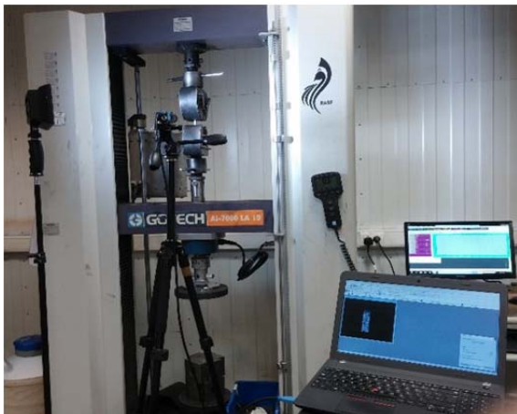
شکل ۴ راه‌اندازی آزمون کشش همراه با تجهیزات همبستگی تصاویر دیجیتال
