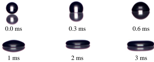
Fig. 9 The glycerin droplet collision with a Plexiglas plane ( We = 545 ) ( We = 538 ) شکل 9 برخورد قطره گلیسرین با یک صفحه پلکسی گلس
