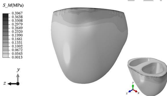
Fig. 7 Mises stress distribution (MPa) in YZ plane and 3D view شکل 7 توزیع تنش مایز بر حسب مگاپاسکال در صفحه YZ و نمای سه بعدی
