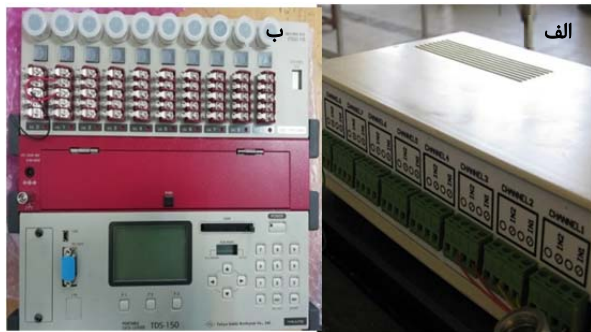
شکل ۳ (الف) دستگاه ثبت داده؛ (ب) دستگاه ثبت داده استفاده‌شده در تحقیق حاضر، (ب) دستگاه ثبت داده TDS-150 استفاده‌شده برای کالیبره‌کردن
