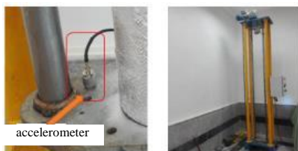
Fig. 9 Drop weight Device and accelerometer connected to it شکل 9 دستگاه سقوط وزنه و شتاب‌سنج متصل شده به آن
