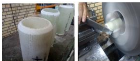
Fig. 7 chamfering the samples with a grinding machine شکل 7 پخ زدن انتهای نمونه‌ها با ماشین تراش
