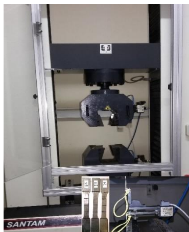
Fig. 7 Steel sheet tensile test
