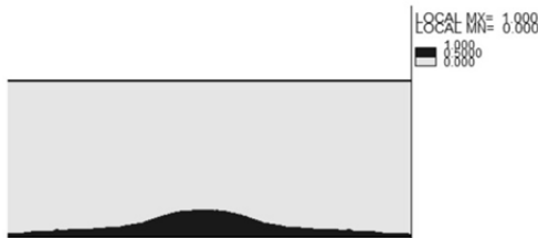
Fig. 2 STAR-CD 2D results for the case of water entrance from middle and bottom of the bed with 0.2m/s speed at 0.5s شکل 2 نتیجه حاصل از نرم افزار استار سی دی برای ورود آب به مخزن از پایین و وسط با سرعت 0.2 متر بر ثانیه در حالت دوبعدی در 0.5 ثانیه
