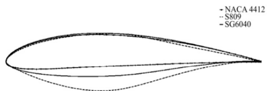
Fig. 7 NACA4412, S809 and SG6040 Airfoil cross sections [26] شکل 7 مقطع ایرفویل‌های ناکا 4412، اس‌جی 6040 و اس 809 [26]
