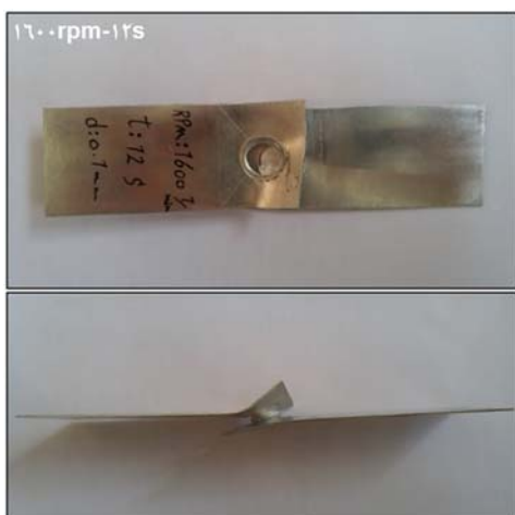
شکل ۹) تصویر ماکروسکوپی از نمونه جوشکاری شده در سرعت دوران ۱۶۰۰rpm و زمان دوران ۱۲s بعد از آزمون کشش برش
