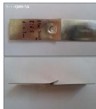
شکل ۱۰) تصویر ماکروسکوپی از نمونه جوشکاری شده در سرعت دوران ۱۰۰۰rpm و زمان دوران ۶s بعد از آزمون کشش برش
