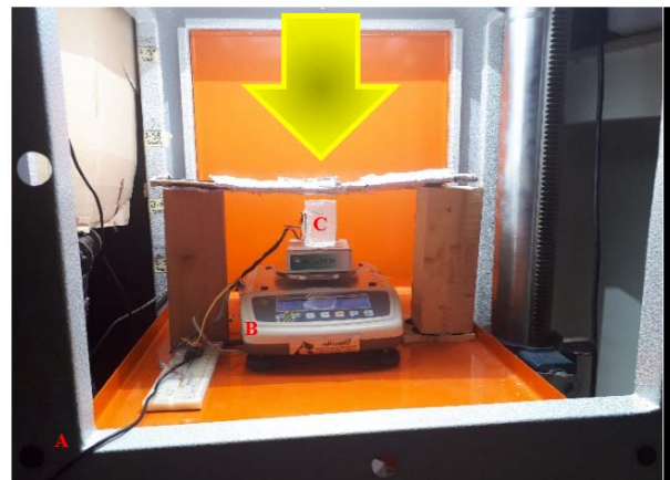
شکل ۱) نمای کلی از مجموعه آزمایشگاهی به‌همراه شبیه‌ساز خورشیدی (A)، ترازو (B) و محفظه شیشه‌ای به‌همراه سنسورها (C)
