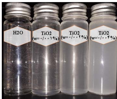
شکل ۳) تصویری از نانوسیال حاوی نانوذرات تیتانیوم اکساید (TiO 2 ) با دردهای جرمی متفاوت در مقایسه با آب
