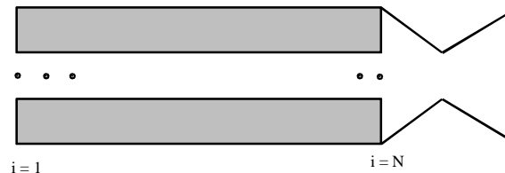
شکل ۳) المان بندی برای حل جریان داخل پورت
