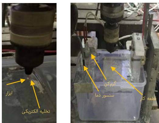
شکل ۳ تجهیزات آزمایشگاهی (الف)، تخلیه الکتریکی روی نوک ابزار (ب)
