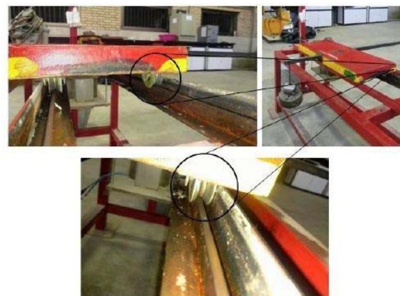
شکل ۵) لقی بین چرخ و ریل و نامنظمی‌های ریل
