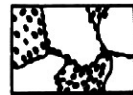
سطح D پرلیت کاملا کروی شده اما کاربیدها همچنان دارای دانه پرلیتی اولیه هستند
