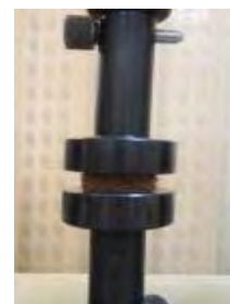
شکل ۹) آزمایش فشار مسطح روی پنل ساندویچی
