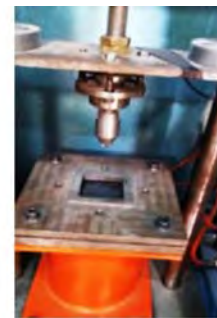
شکل (۱۰) آزمایش ضربه روی پنل ساندویچی
