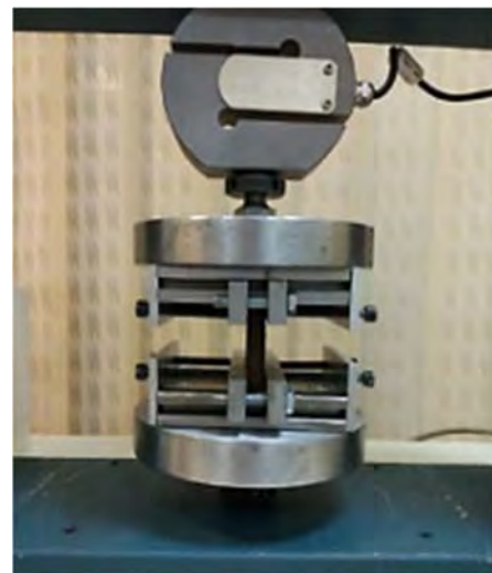
شکل ۶) آزمایش فشار لبه‌ای روی پنل ساندویچی
