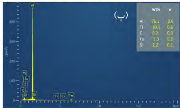
نمودار ۱) طیف‌سنجی پراش انرژی اشعه ایکس نمونه آلومینیوم ۶۰۶۱ (الف) قبل از فرآیند اصطکاکی اغتشاشی و (ب) پس از فرآیند اصطکاکی اغتشاشی با ۲۰wt% دی‌بوراید تیتانیم و ۱wt% گرافن.
