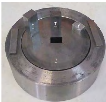
شکل ۱) تصویر قالب MDF و سنبه‌های تهیه‌شده برای پژوهش حاضر (۱- قالب، ۲- سنبه بزرگ، ۳- سنبه کوچک و ۴- نمونه)
