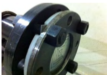
شکل ۵) موقعیت‌دهی ورق برای بررسی تغییر فرم ورق با نرخ کرنش بالا
