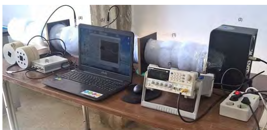
شکل ۳) نمایی از تجهیزات و نحوه اتصال آنها، (۱) لوله امیدانس، (۲) بلندگو، (۳) دستگاه مولد، (۴) و (۵) میکروفون‌ها، (۶) رایانه، (۷) نمونه اسفنچ، (۸) کارت صدا
