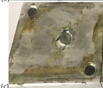
شکل ۷) عمق نفوذ در پشتیبان به‌وسیله پرتابه با دماغه تخت (a)، نیم‌کره (b) و اجایو (c)
