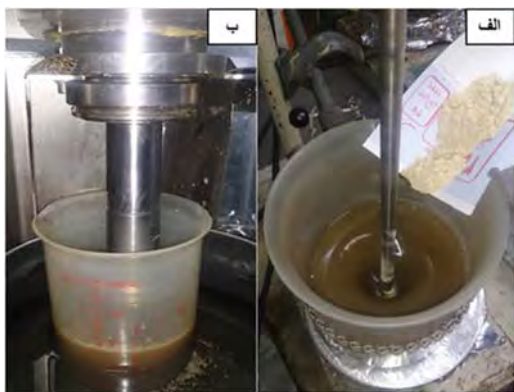
شکل ۱) ترکیب پودر نانو توسط دستگاه همزن اولتراسونیک
