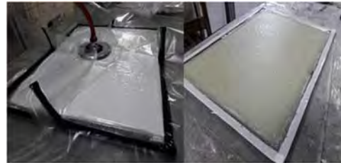
شکل ۲) ساخت لمینیت کامپوزیت
