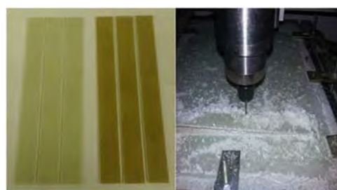
شکل ۴) برشکاری نمونه‌های کپن تست برای آزمون کشش توسط دستگاه CNC
