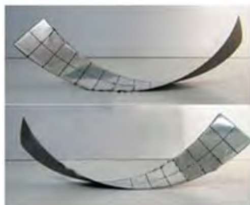
شکل ۲) حالت‌های پایدار ورق مرکب دوپایا با چینش [0_m/90_n/90_m]_T [28]
