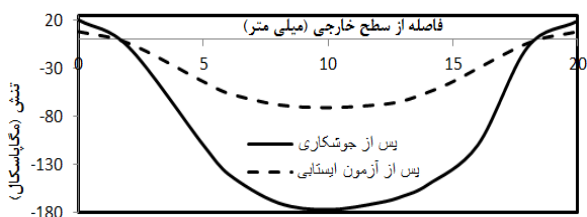
نمودار ۸) توزیع تنش پسماند در راستای ضخامت و در مرکز درز جوش (σ z )
