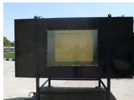
شکل ۳) مخزن ساخته‌شده جهت انجام آزمون آب ساکن
