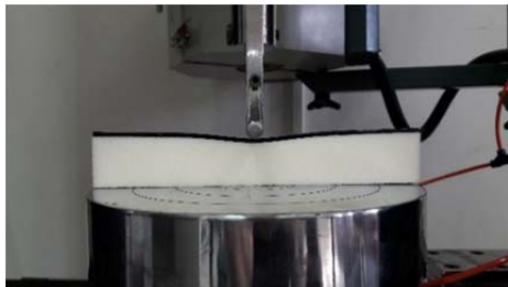
شکل ۶) ساختار ساندویچی حین تست تورفتگی
