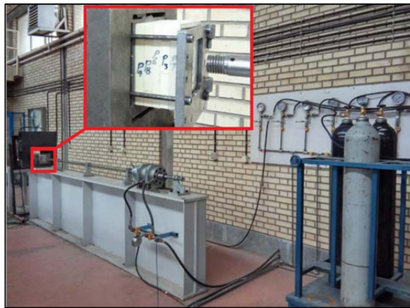
شکل ۴) نمایی از دستگاه آزمایش و نمونه قرارداده شده در فیکسچر آن
