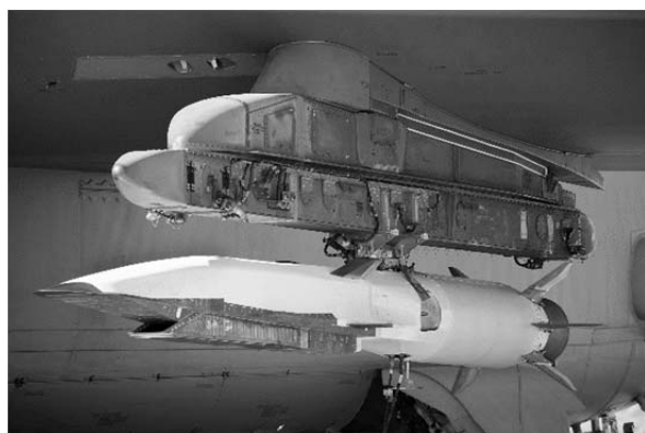
شکل ۲) پرنده ایکس-۵۱ با موتور اسکرم‌جت به همراه بوستر سوخت جامد آن [7]
