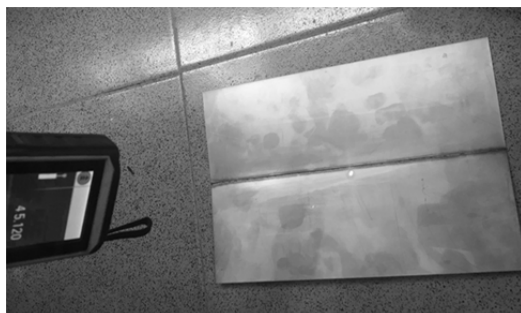
شکل ۸) اندازه‌گیری دمای سطح ورق در نزدیکی خط جوش
