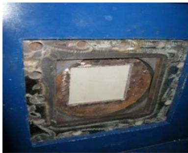
شکل ۵) محل قرارگیری هدف در فیکسچر
