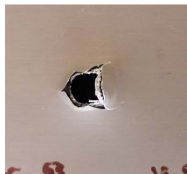
شکل ۱۴) نمای پشت یکی از نمونه‌های سری دوم پس از برخورد
