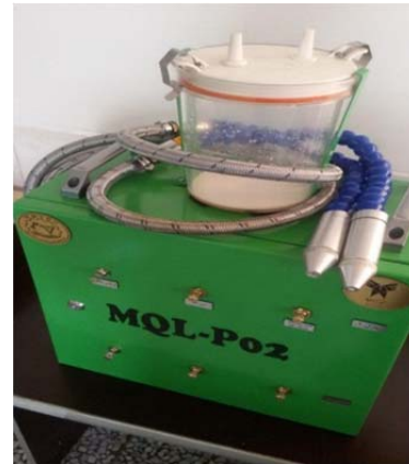
شکل ۲ دستگاه حداقل مقدار روان کار استفاده شده در آزمایش ها
