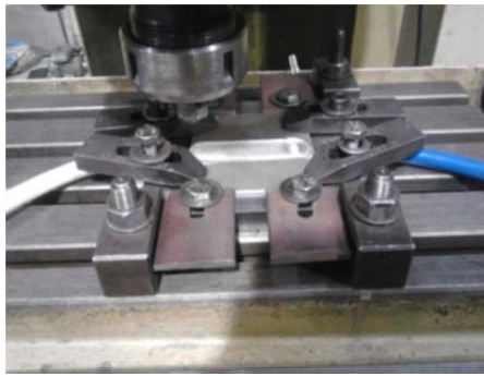
شکل ۱) تصویر نگهدارنده مجهز به سیستم آبگرد برای انجام جوشکاری
